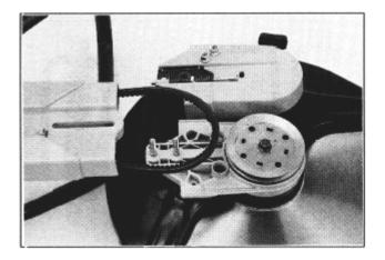
**Ремень** при работе полностью закрыт и хорошо защищен от пыли и грязи, так же как от механического повреждения.
