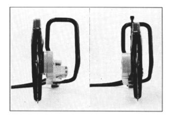
Существует возможность перевернуть консоль на 180° так, чтобы диск оказался на противоположной стороне консоли. Это облегчает резку вблизи препятствий типа стен, полов и т.д. Консоль резака, кожух и приводной ремень снимаются тем же самым способом, как и при замене приводного ремня.
