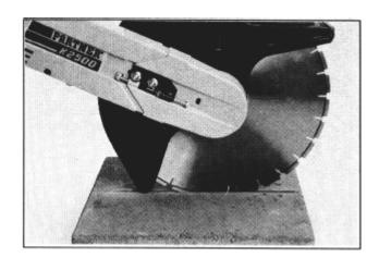
Шпиндель защищен посредством штифта 503 24 06-02, который максимально вдвинут. Диск зажимается по часовой стрелке.
