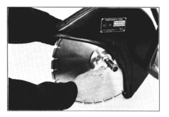
**Колесо** устанавливается между фланцами A и B. Проверьте защитную втулку, чтобы она соответствовала размеру отверстия в диске. Перед затяжкой винта проверьте, чтобы внешний фланец был правильно посажен на вал.
